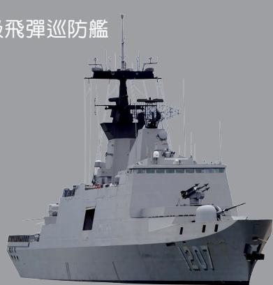
擔負海疆防禦及聯合水面截擊作戰任務。可執行防空、反潛、護航、反封鎖，並以匿蹤化的艦體設計，全艦避免複雜造型或是菱角結構，可分散雷達波進而達隱匿效果。
