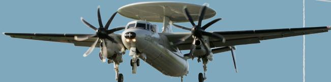
擔負偵蒐及作戰指管任務。屬機翼可以折收的艦載型空中預警機，裝有各種先進裝置與雷達，可有效作為協同接戰之載臺。
