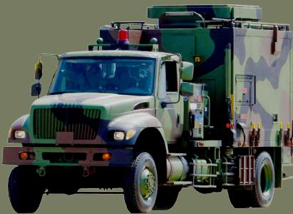
擔負野戰防空區域預警暨火力分配任務。由「相列雷達」及「接戰管制」次系統組成，能對定翼機、旋翼機等目標進行偵蒐及追蹤，具先期發現威脅目標，提供預警功能，並依目標威脅程度排序，增加接戰準備時間，提升整體野戰防空作戰效能。
