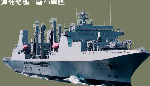
擔負一般油彈補給任務及物資運輸功能。為海上機動整補艦，在航行期間能同時為2側各1艘船艦進行油料與彈藥物資補給；另於艦首甲板與船艙各有一對起重機，用來裝卸物資。
