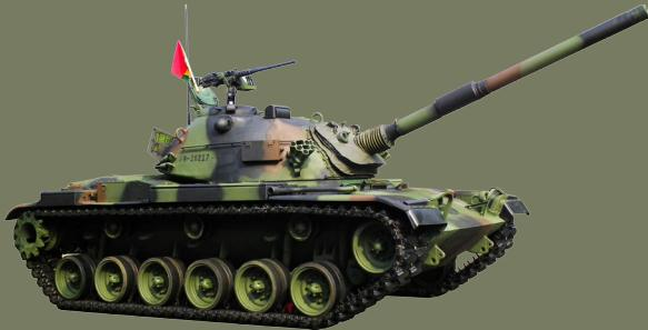
擔負支援步兵與反登陸作戰任務。主砲配有砲身二維穩定儀，並配合新式射控系統、雷射測距儀及熱影像儀等裝備，具有行進間射擊和夜戰能力的主戰車。
