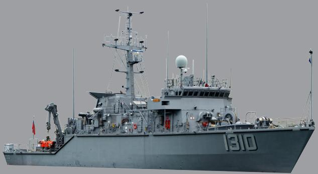
擔負反封鎖作戰及獵雷任務。全船為玻璃纖維製，不具磁性、雷達反射面積小、航行音頻低，並藉由裝備之水雷處理器（無人載具），偵蒐各型水雷，及清除水雷。
